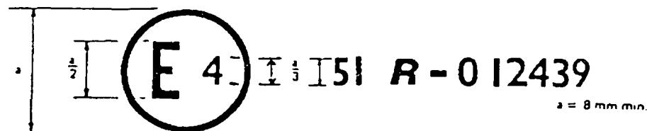
La marque d'homologation ci-dessus, apposée sur un véhicule, indique que le type de ce véhicule a été homologué aux Pays-Bas (E 4), en ce qui concerne le bruit, en application du Règlement No 51 et sous le numéro d'homologation 012439. Les deux premiers chiffres du numéro d'homologation signifient que le Règlement No 51 comprenait déjà la série 01 d'amendements lorsque l'homologation a été délivrée.
